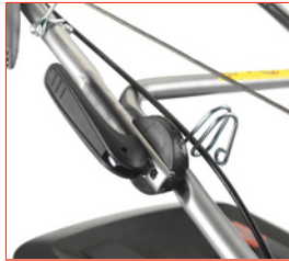
Schnellspanner und solide Bowdenzugführungen
