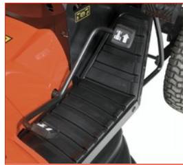
Stufenloses Hydrostatikgetriebe mit unkomplizierter Fußhebelbedienung und Rückwärtsfahrt.
