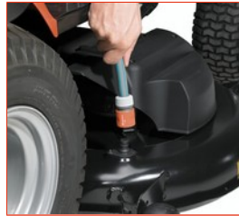
Wasseranschluß für schnelle Mähdeckreinigung
