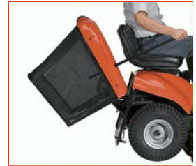
Grasfangkorbentleerung mit Teleskophebel
